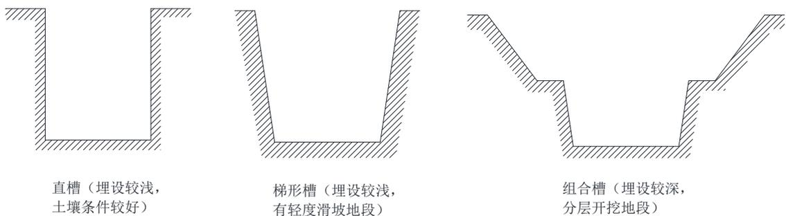
图 1 管槽断面形状
